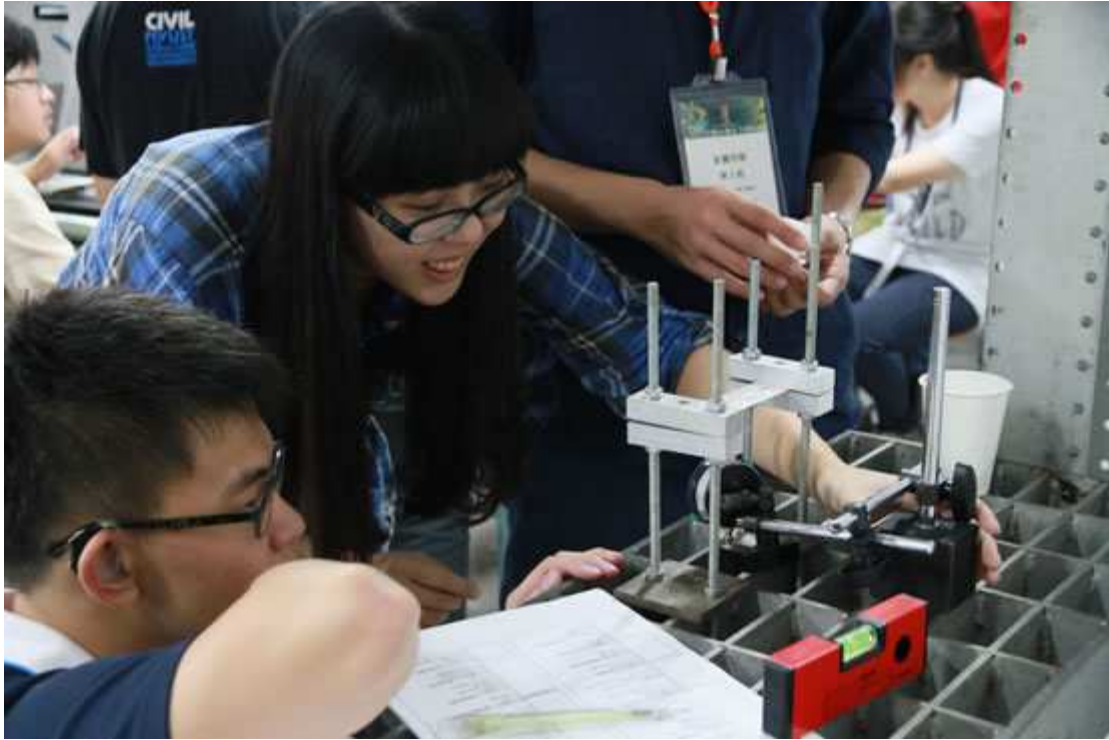
結構撓曲勁度測試
