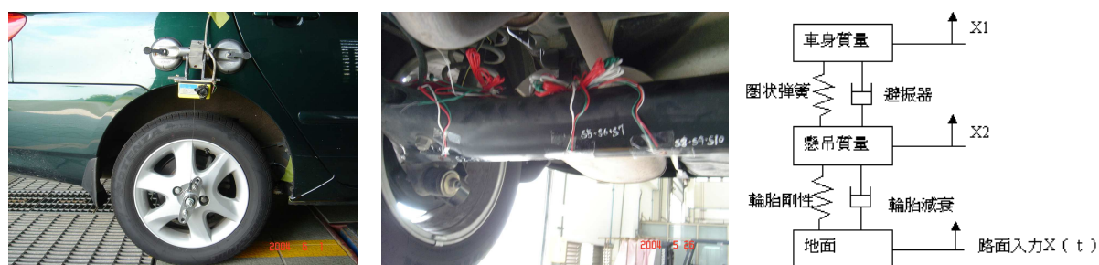
圖二、試驗設備及架設位置示意圖（左：變位計、中：加速規&應變規、右：四分之一車數值計算模型）
